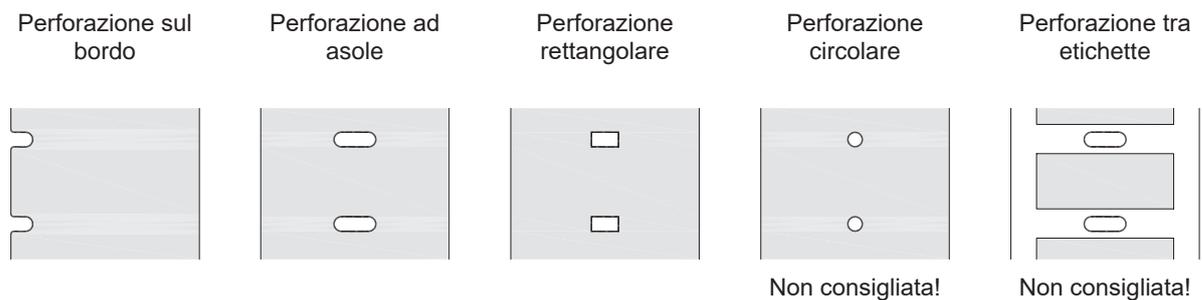
Figura 27 Esempi di perforazioni
