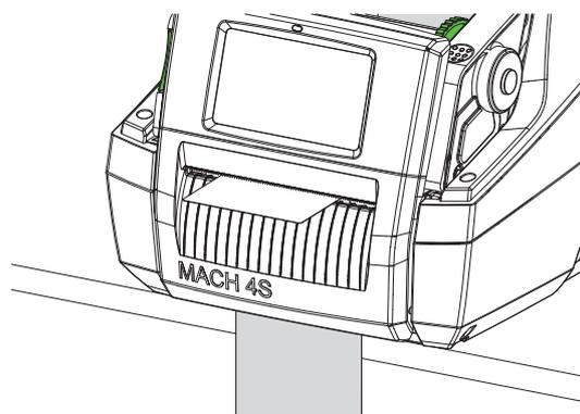
Figura 14 Caricamento delle etichette per la modalità distribuzione
