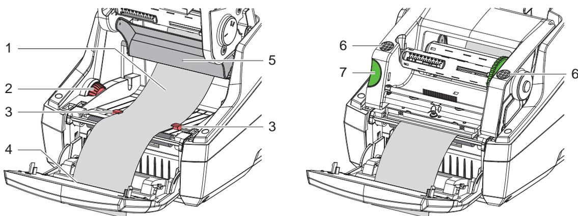
Figura 11 Caricamento delle etichette nel modulo di trasporto
