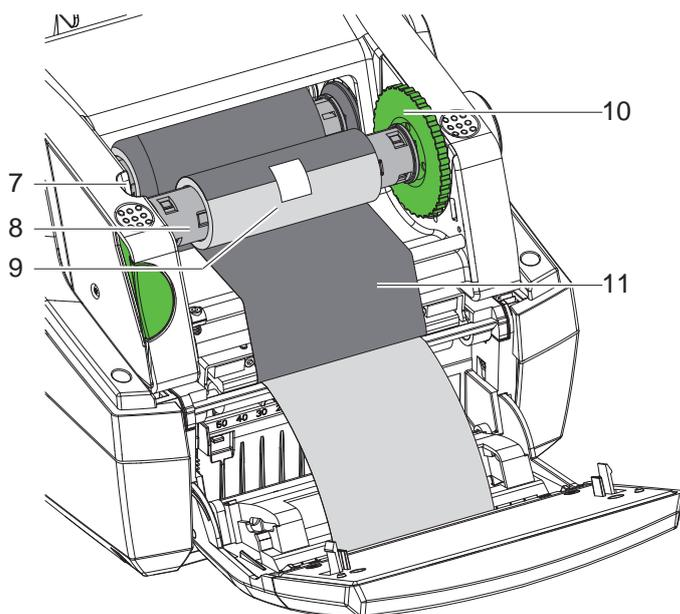
Figura 19 Inserimento del nastro
