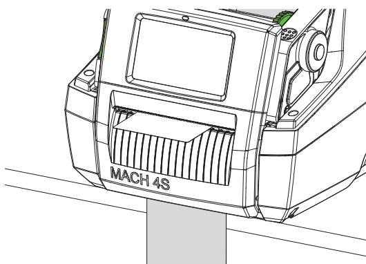
Slika 14 Vstavljanje etiket za način odlepljanja
