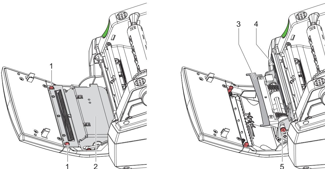
Slika 21 Čiščenje rezalnika
