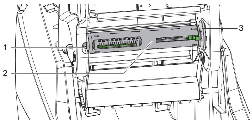
Slika 17 Snemanje jedra prenosne folije na odvijalniku
